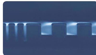
新技術によるグラビアオフセット印刷版の断面
