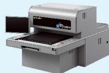
プリント基板用外観検査装置「PI-9500」
