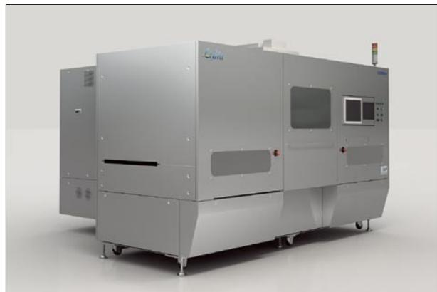
プリント配線板業界では従来、回路基板の製作には、フィルムまたはガラス製の「フォトマスク」と呼ばれるパターン原版に光を当て、基板の感光面全体に回路を転写する露光方式が使用されてきました。しかし近年、スマートフォンやタブレット端末の急激な普及を受け、高密度・高精細化への対応に加え、欠陥発生率の抑制とさらなる生産性の向上が同時に求められています。そのため、フォトマスクを使うことなく、より精密な回路パターンを歩留まり良く露光できる直接描画装置へのシフトが、急速に進んでいます。
